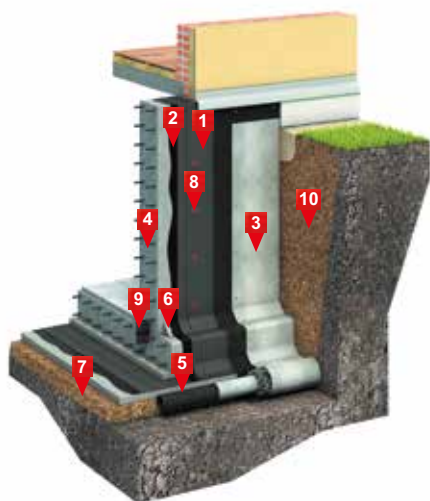
Рисунок А.3 — Конструктивный состав системы ТН-ФУНДАМЕНТ Дренаж Лайт
