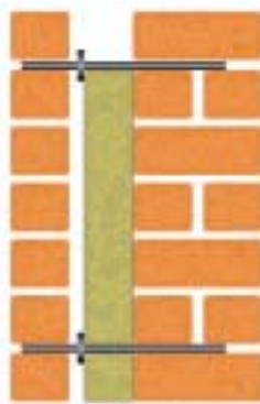
Рисунок 5.2 — Разрез фасада с расположением гибких связей
