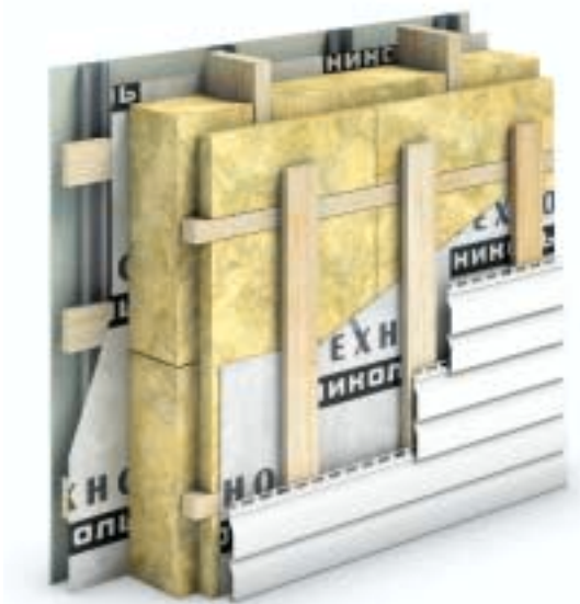
Рисунок 6.1 — Система фасада по деревянному каркасу. Общий вид
