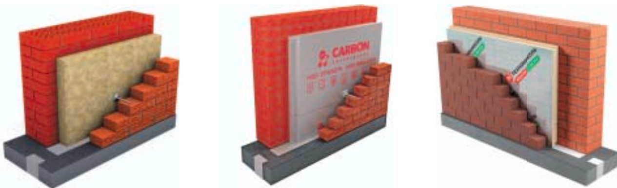
Рисунок 5.1 — Система фасада с облицовкой из кирпича с утеплением из каменной ваты, экструзионного пенополистирола и пенополиизоцианурата. Общий вид
